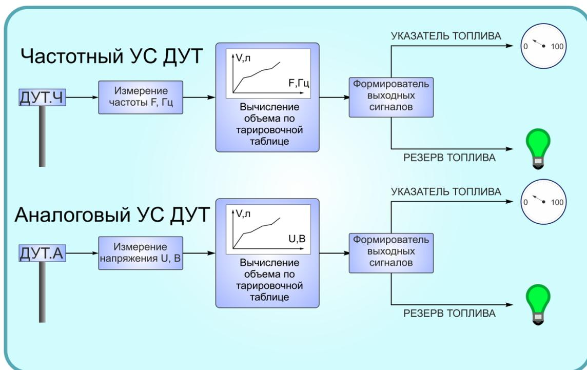
Рисунок 2 – Структурная схема УС ДУТ
