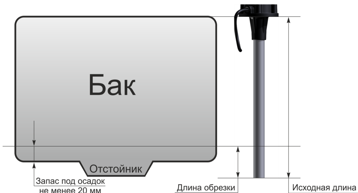
Рисунок 11 – Схема обрезки датчика
