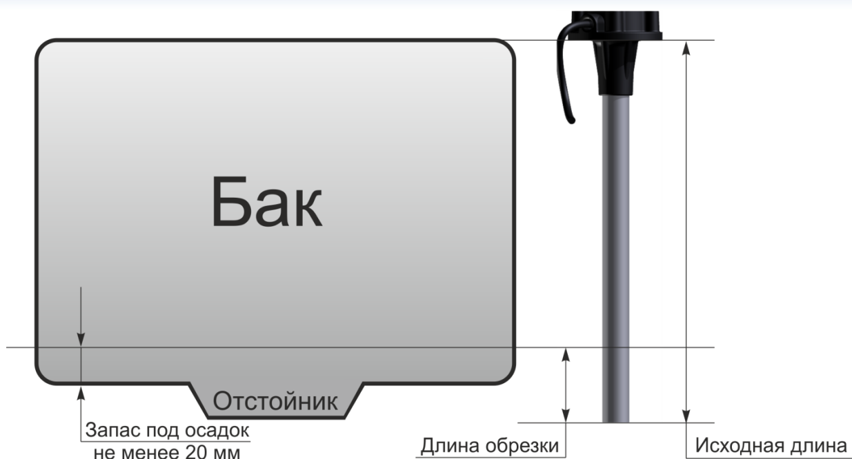
Рисунок 12 – Схема обрезки датчика
